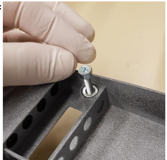
Abb. 46: Einkleben der Tubtara Blindmuttern
